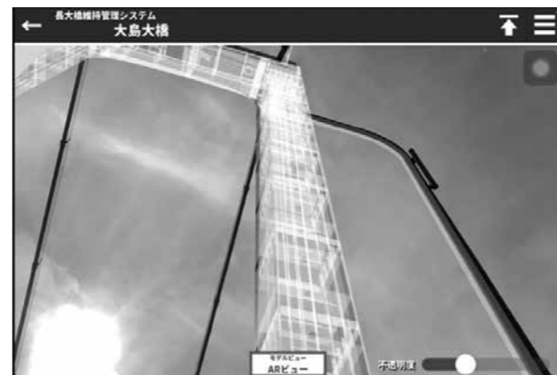
BIMモデルと現実画像の重量(大島大橋)
