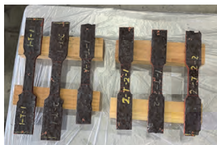
引張試験体の形状
