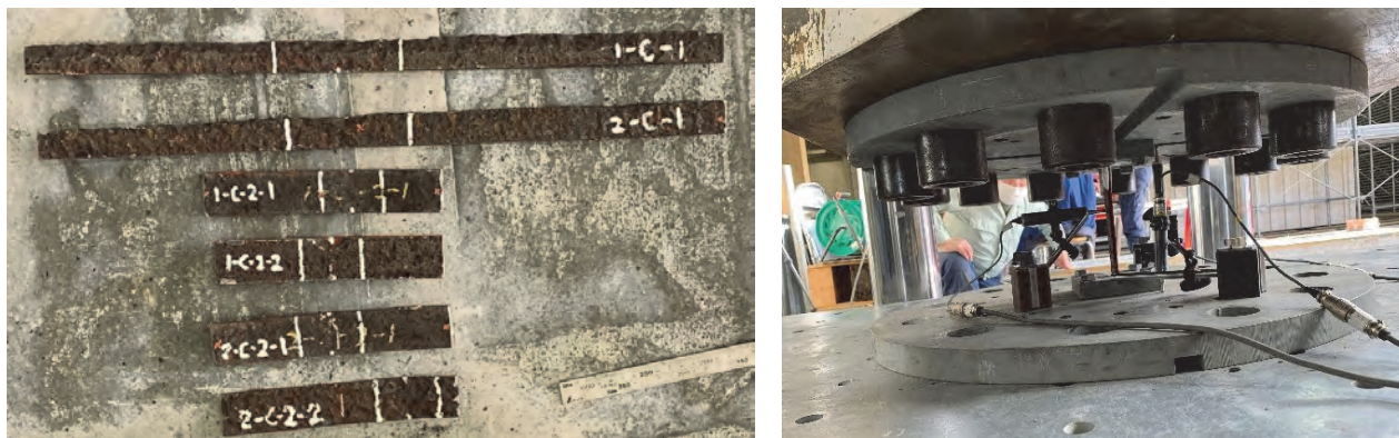
写真 5.8.5 圧縮試験片及び試験状況（ものづくり大学）
