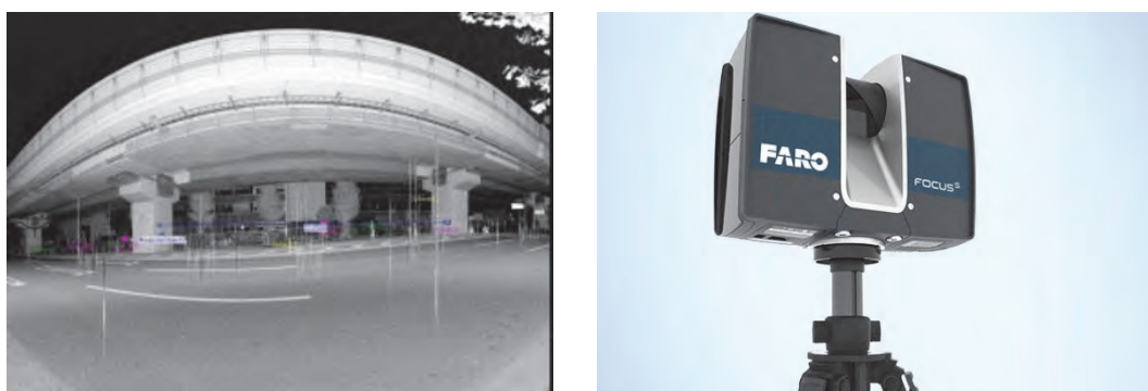
図 3.2.5 スキャン画像とレーザースキャナ 6)
