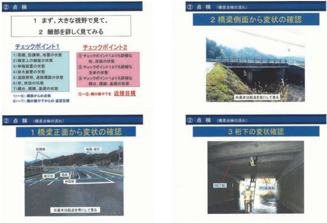
図 3.3.6 島根県道路橋定期点検要領の抜粋
