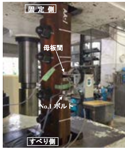
図 4-3-3 変位計測位置
