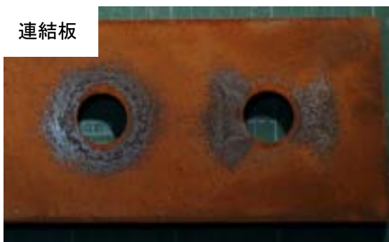
付図 3-2-31 試験体 C-a-1 すべり面の状況（左：ボルト側，右：ナット側）
