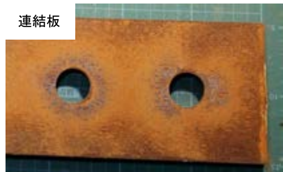
付図 3-2-29 試験体 C-n-2 すべり面の状況 (左 : ボルト側, 右 : ナット側)
