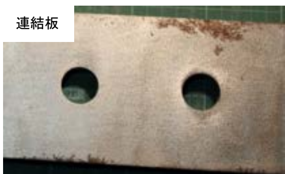
付図 3-2-21 試験体 C-v-3 すべり面の状況（左：ボルト側，右：ナット側）
