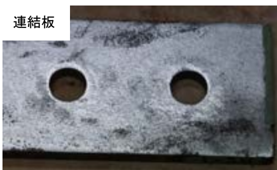
付図 3-3-13 試験体 C-g-1 すべり面の状況 (左 : ボルト側, 右 : ナット側)
