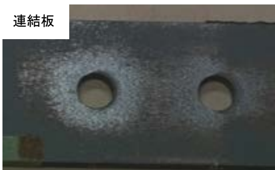
付図 3-3-7 試験体 B-n2-1 すべり面の状況（左：ボルト側，右：ナット側）
