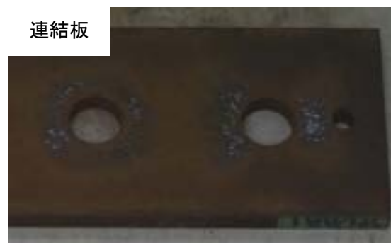
付図 3-3-19 試験体 C-n2-1 すべり面の状況 (左：ボルト側, 右：ナット側)
