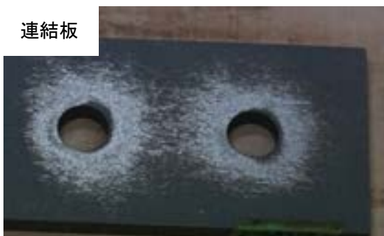
付図 3-3-8 試験体 B-n2-2 すべり面の状況（左：ボルト側，右：ナット側）
