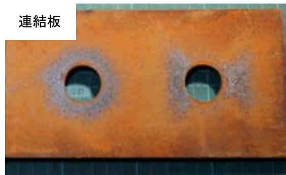
付図 3-2-33 試験体 C-a-3 すべり面の状況（左：ボルト側，右：ナット側）
