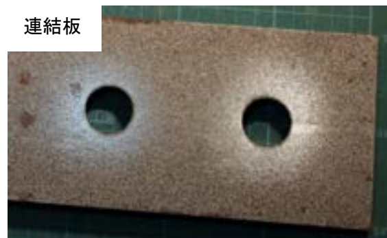
付図 3-2-18 試験体 C-b-3 すべり面の状況 (左：ボルト側, 右：ナット側)
