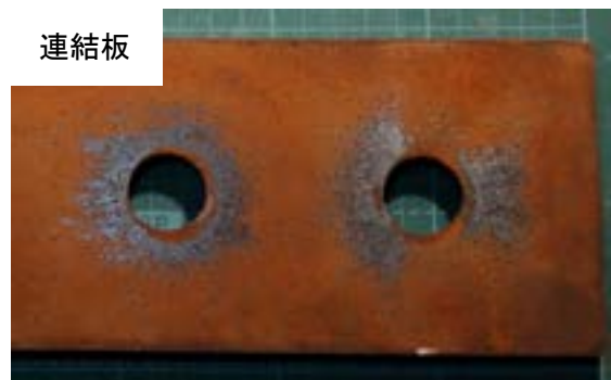
付図 3-2-32 試験体 C-a-2 すべり面の状況（左：ボルト側，右：ナット側）
