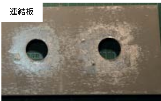
付図 3-2-12 試験体 B-o-3 すべり面の状況 (左：ボルト側, 右：ナット側)
