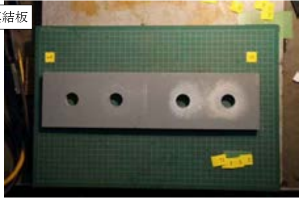
付図 1-3-6 試験体 P2-15-3 すべり面の状況 (左: ボルト側, 右: ナット側)
