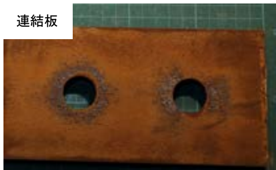
付図 3-2-29 試験体 C-n-2 すべり面の状況 (左 : ボルト側, 右 : ナット側)
