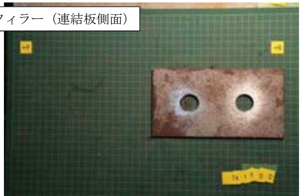
付図 1-3-31 試験体 B4-10-1 すべり面の状況 (左: ボルト側, 右: ナット側)
