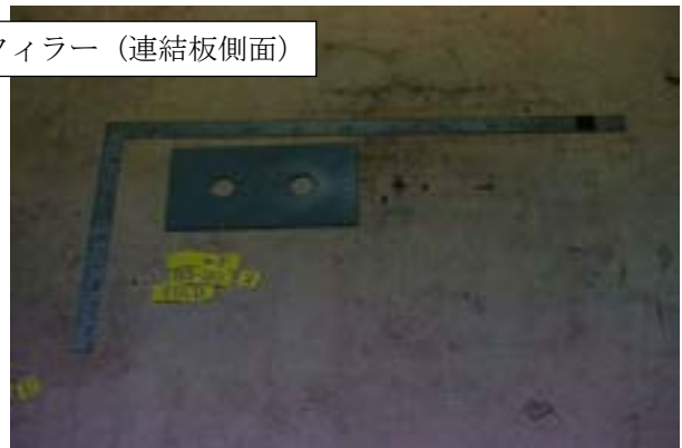
付図 1-3-53 試験体 PB4-20-2 すべり面の状況 (左: ボルト側, 右: ナット側)
