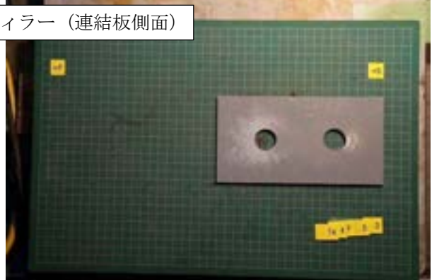
付図 1-3-16 試験体 P4-20-1 すべり面の状況 (左: ボルト側, 右: ナット側)
