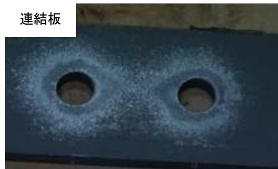
付図 3-3-17 試験体 C-i2-2 すべり面の状況 (左：ボルト側, 右：ナット側)
