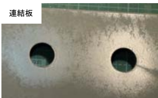
付図 3-2-4 試験体 A-n-1 すべり面の状況（左：ボルト側，右：ナット側）
