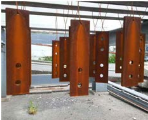
図 3-2-3 接触面 n の屋外曝露状況
