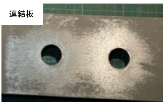
付図 3-2-7 試験体 B-v-1 すべり面の状況（左：ボルト側，右：ナット側）
