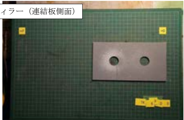
付図 1-3-18 試験体 P4-20-3 すべり面の状況 (左: ボルト側, 右: ナット側)
