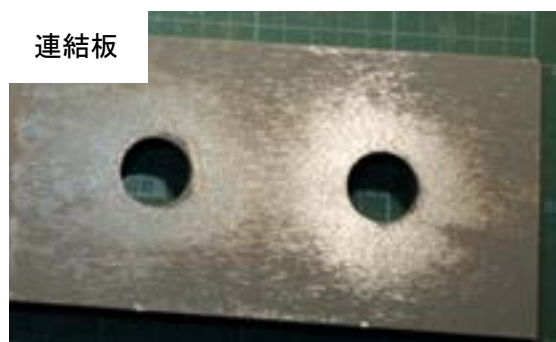
付図 3-2-5 試験体 A-n-2 すべり面の状況（左：ボルト側，右：ナット側）
