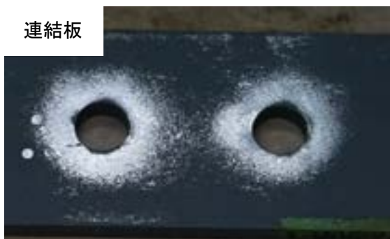
付図 3-3-6 試験体 B-g-3 すべり面の状況 (左: ボルト側, 右: ナット側)
