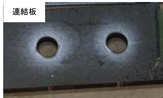
付図 3-3-12 試験体 C-b2-3 すべり面の状況 (左：ボルト側, 右：ナット側)
