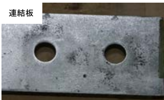
付図 3-3-14 試験体 C-g-2 すべり面の状況 (左 : ボルト側, 右 : ナット側)
