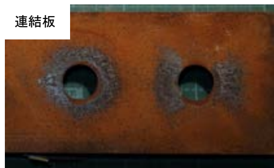
付図 3-2-31 試験体 C-a-1 すべり面の状況（左：ボルト側，右：ナット側）
