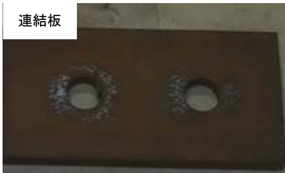
付図 3-3-20 試験体 C-n2-2 すべり面の状況 (左：ボルト側, 右：ナット側)
