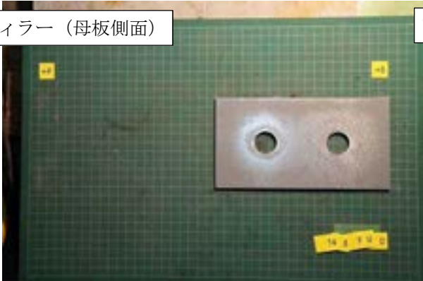
付図 1-3-17 試験体 P4-20-2 すべり面の状況 (左: ボルト側, 右: ナット側)
