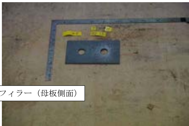
付図 1-3-51 試験体 PB3-15-3 すべり面の状況 (左: ボルト側, 右: ナット側)
