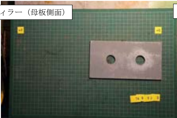
付図 1-3-18 試験体 P4-20-3 すべり面の状況 (左: ボルト側, 右: ナット側)
