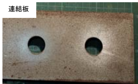
付図 3-2-16 試験体 C-b-1 すべり面の状況 (左：ボルト側, 右：ナット側)
