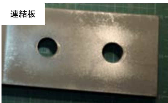
付図 3-2-6 試験体 A-n-3 すべり面の状況（左：ボルト側，右：ナット側）
