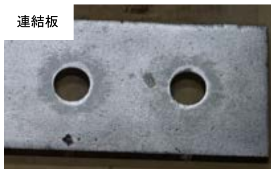
付図 3-3-14 試験体 C-g-2 すべり面の状況 (左 : ボルト側, 右 : ナット側)
