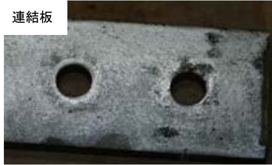
付図 3-3-15 試験体 C-g-3 すべり面の状況 (左：ボルト側, 右：ナット側)
