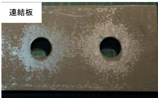
付図 3-2-25 試験体 C-o-1 すべり面の状況 (左 : ボルト側, 右 : ナット側)
