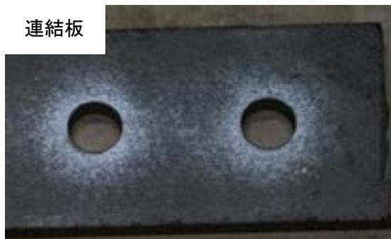
付図 3-3-12 試験体 C-b2-3 すべり面の状況 (左：ボルト側, 右：ナット側)
