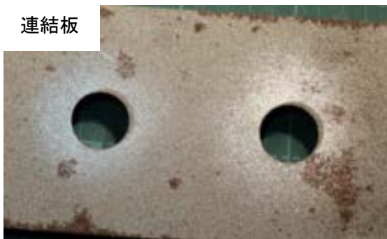
付図 3-2-17 試験体 C-b-2 すべり面の状況 (左：ボルト側, 右：ナット側)
