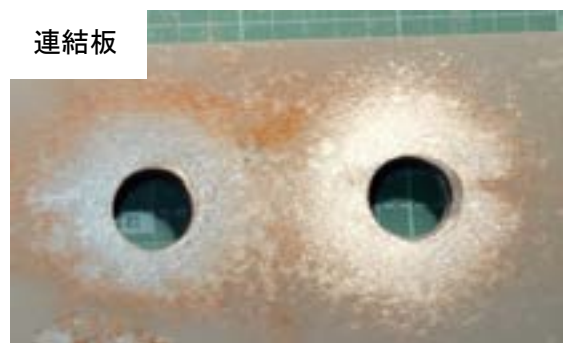
付図 3-2-15 試験体 B-a-3 すべり面の状況 (左：ボルト側, 右：ナット側)
