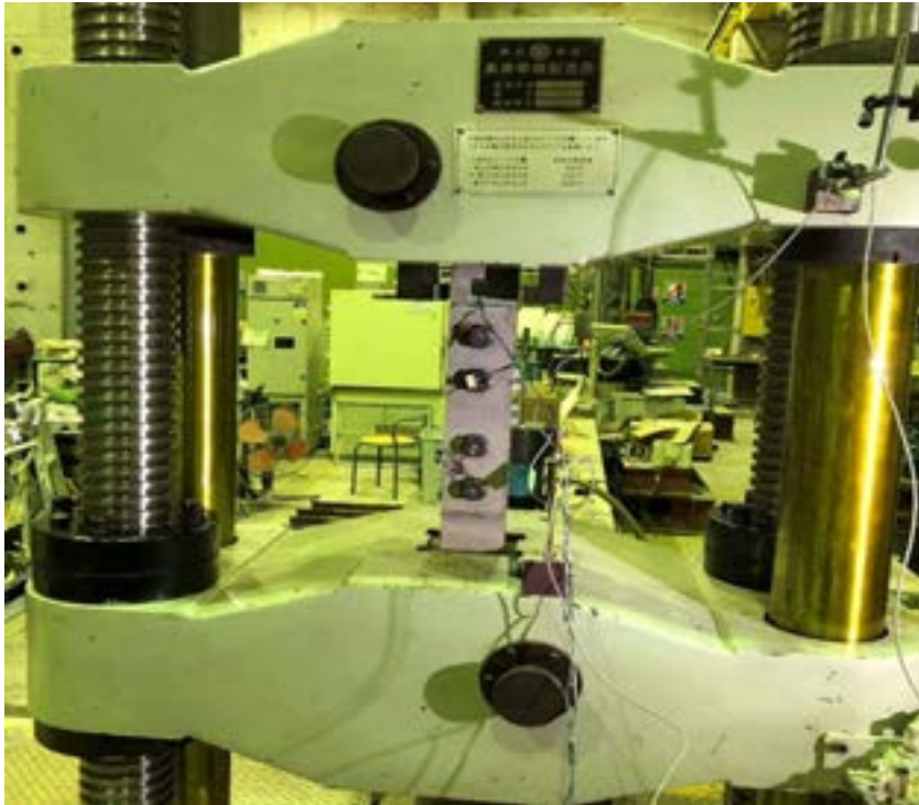
図 3-6-1 すべり耐力試験の状況
