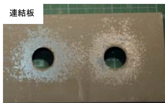
付図 3-2-27 試験体 C-o-3 すべり面の状況（左：ボルト側，右：ナット側）
