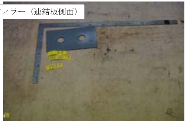
付図 1-3-54 試験体 PB4-20-3 すべり面の状況 (左: ボルト側, 右: ナット側)
