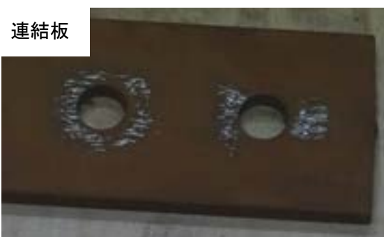
付図 3-3-21 試験体 C-n2-3 すべり面の状況 (左：ボルト側, 右：ナット側)
