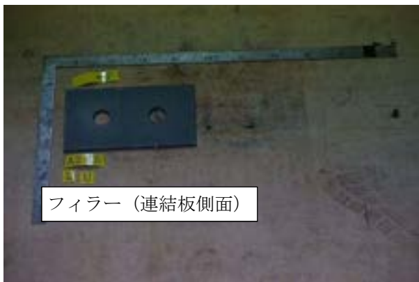
付図 1-3-42 試験体 PA3-15-3 すべり面の状況 (左 : ボルト側, 右 : ナット側)
