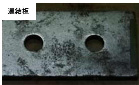
付図 3-3-13 試験体 C-g-1 すべり面の状況 (左 : ボルト側, 右 : ナット側)
