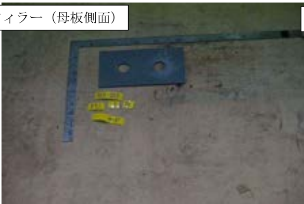
付図 1-3-52 試験体 PB4-20-1 すべり面の状況 (左 : ボルト側, 右 : ナット側)
