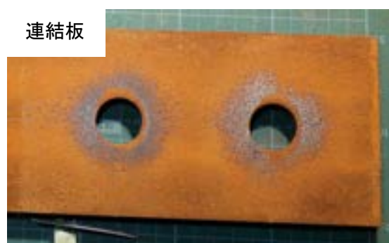
付図 3-2-28 試験体 C-n-1 すべり面の状況（左：ボルト側，右：ナット側）
