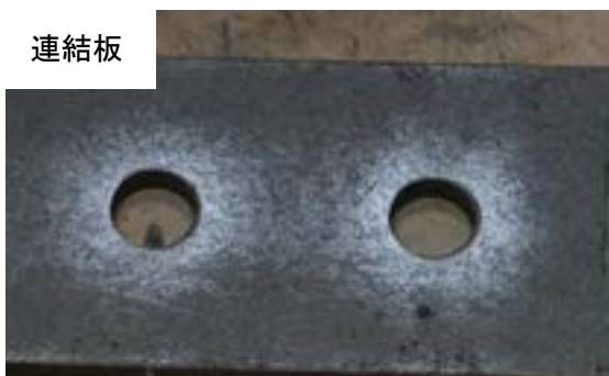
付図 3-3-10 試験体 C-b2-1 すべり面の状況 (左 : ボルト側, 右 : ナット側)
