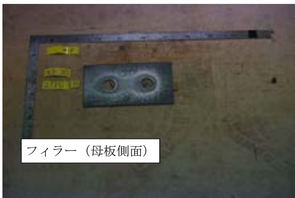
付図 1-3-44 試験体 PA4-20-2 すべり面の状況 (左 : ボルト側, 右 : ナット側)
