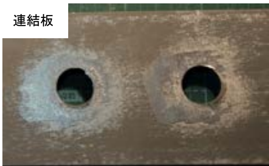
付図 3-2-11 試験体 B-o-2 すべり面の状況 (左：ボルト側, 右：ナット側)
