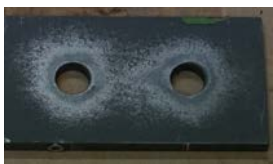
付図 3-3-16 試験体 C-i2-1 すべり面の状況 (左：ボルト側, 右：ナット側)
