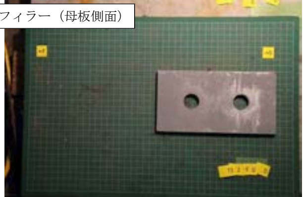
付図 1-3-8 試験体 P3-15-2 すべり面の状況 (左 : ボルト側, 右 : ナット側)
