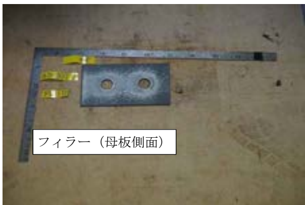
付図 1-3-43 試験体 PA4-20-1 すべり面の状況 (左: ボルト側, 右: ナット側)
