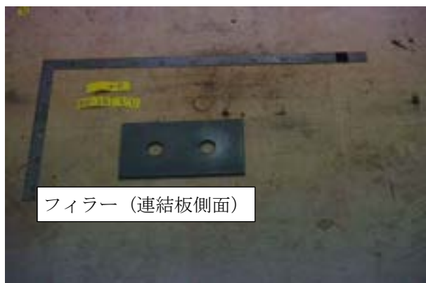
付図 1-3-49 試験体 PB3-15-1 すべり面の状況 (左 : ボルト側, 右 : ナット側)
