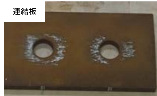
付図 3-3-20 試験体 C-n2-2 すべり面の状況 (左：ボルト側, 右：ナット側)
