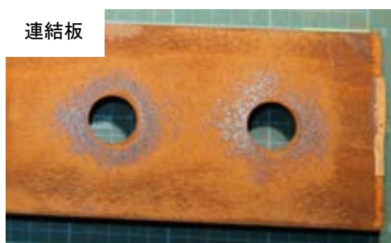
付図 3-2-28 試験体 C-n-1 すべり面の状況（左：ボルト側，右：ナット側）
