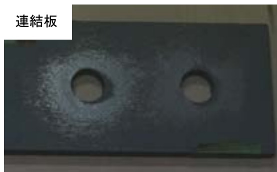
付図 3-3-7 試験体 B-n2-1 すべり面の状況（左：ボルト側，右：ナット側）
