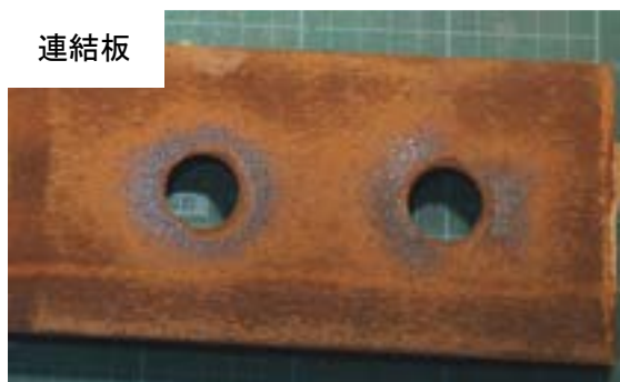
付図 3-2-30 試験体 C-n-3 すべり面の状況 (左 : ボルト側, 右 : ナット側)
