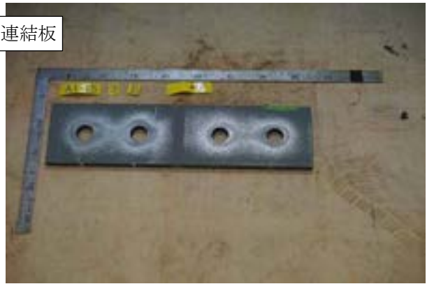
付図 1-3-39 試験体 PA2-15-3 すべり面の状況 (左 : ボルト側, 右 : ナット側)
