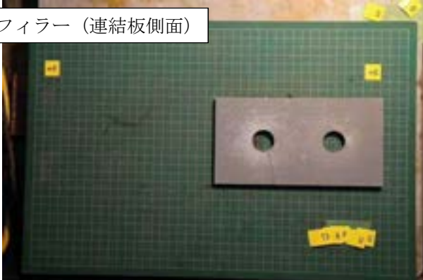
付図 1-3-12 試験体 P3-20-3 すべり面の状況 (左: ボルト側, 右: ナット側)
