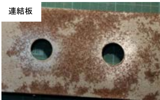
付図 3-2-18 試験体 C-b-3 すべり面の状況 (左：ボルト側, 右：ナット側)
