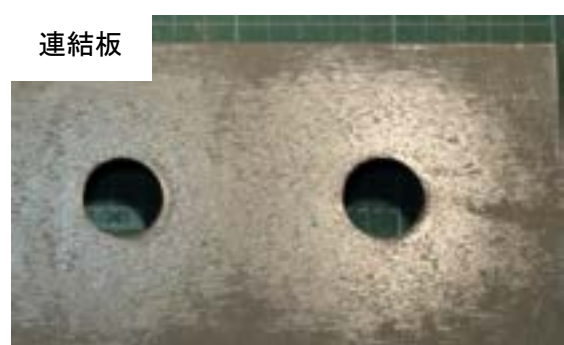
付図 3-2-9 試験体 B-v-3 すべり面の状況（左：ボルト側，右：ナット側）
