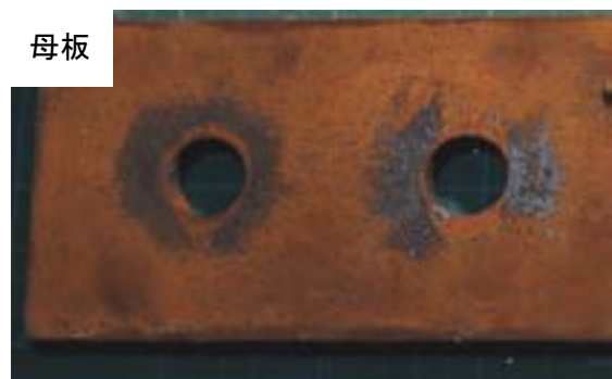
付図 3-2-31 試験体 C-a-1 すべり面の状況（左：ボルト側，右：ナット側）
