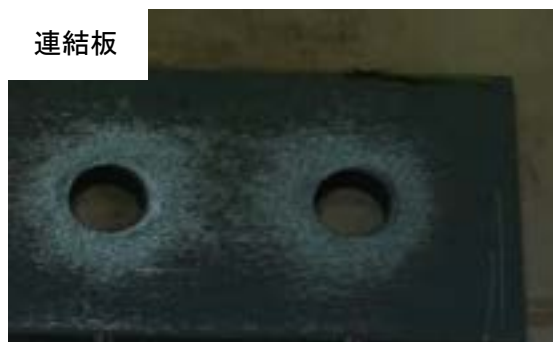
付図 3-3-8 試験体 B-n2-2 すべり面の状況（左：ボルト側，右：ナット側）
