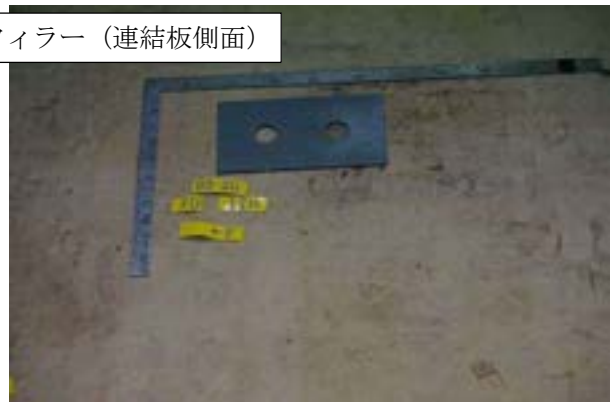
付図 1-3-52 試験体 PB4-20-1 すべり面の状況 (左 : ボルト側, 右 : ナット側)
