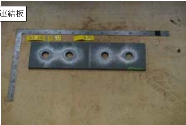
付図 1-3-39 試験体 PA2-15-3 すべり面の状況 (左 : ボルト側, 右 : ナット側)
