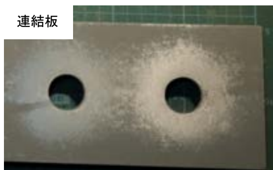
付図 3-2-22 試験体 C-i-1 すべり面の状況（左：ボルト側，右：ナット側）
