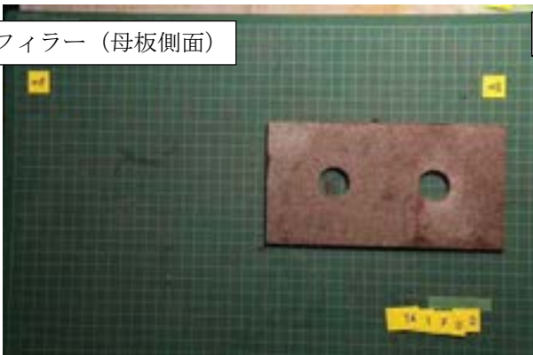
付図 1-3-31 試験体 B4-10-1 すべり面の状況 (左: ボルト側, 右: ナット側)
