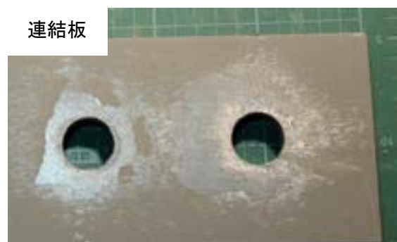
付図 3-2-10 試験体 B-o-1 すべり面の状況（左：ボルト側，右：ナット側）
