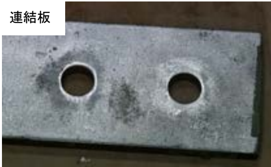
付図 3-3-15 試験体 C-g-3 すべり面の状況 (左：ボルト側, 右：ナット側)
