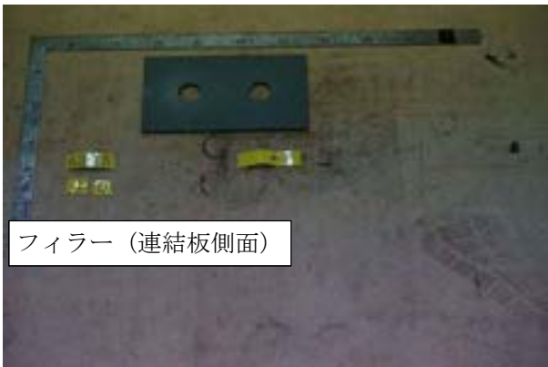
付図 1-3-40 試験体 PA3-15-1 すべり面の状況 (左: ボルト側, 右: ナット側)
