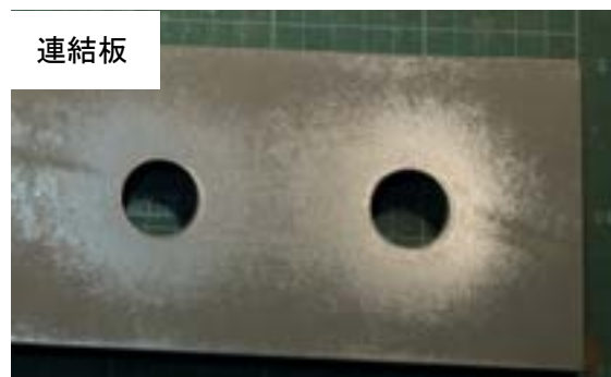
付図 3-2-24 試験体 C-i-3 すべり面の状況 (左：ボルト側, 右：ナット側)
