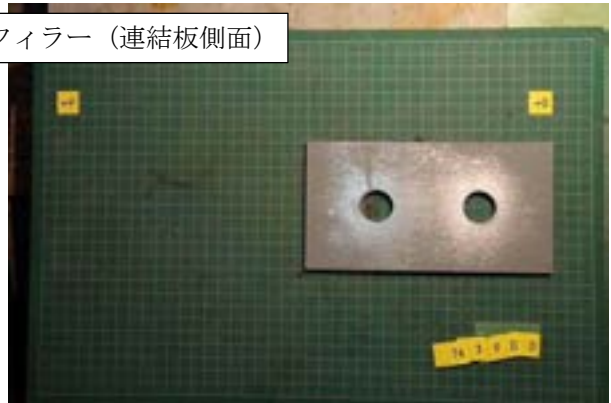
付図 1-3-15 試験体 P4-15-3 すべり面の状況 (左: ボルト側, 右: ナット側)
