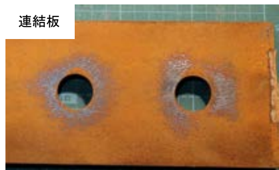
付図 3-2-30 試験体 C-n-3 すべり面の状況 (左 : ボルト側, 右 : ナット側)
