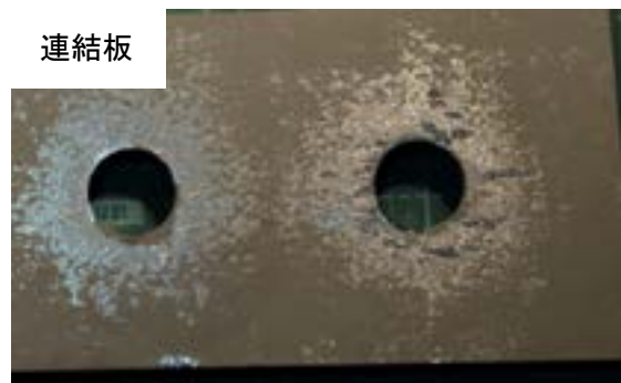
付図 3-2-26 試験体 C-o-2 すべり面の状況 (左 : ボルト側, 右 : ナット側)
