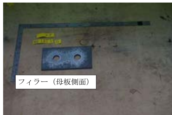
付図 1-3-49 試験体 PB3-15-1 すべり面の状況 (左 : ボルト側, 右 : ナット側)
