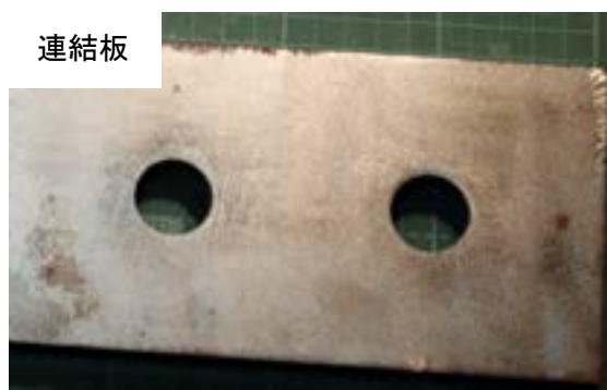
付図 3-2-19 試験体 C-v-1 すべり面の状況 (左 : ボルト側, 右 : ナット側)
