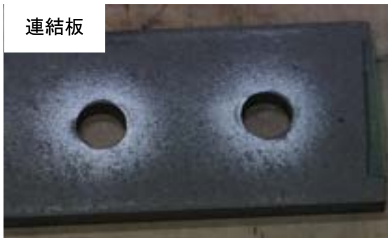
付図 3-3-11 試験体 C-b2-2 すべり面の状況 (左：ボルト側, 右：ナット側)
