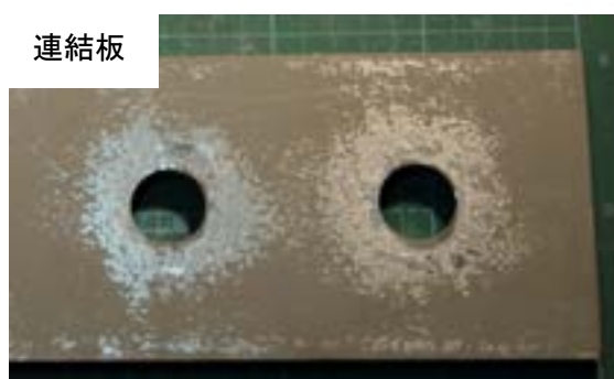
付図 3-2-27 試験体 C-o-3 すべり面の状況（左：ボルト側，右：ナット側）
