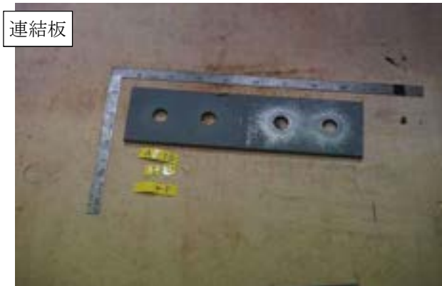
付図 1-3-37 試験体 PA2-15-1 すべり面の状況 (左: ボルト側, 右: ナット側)
