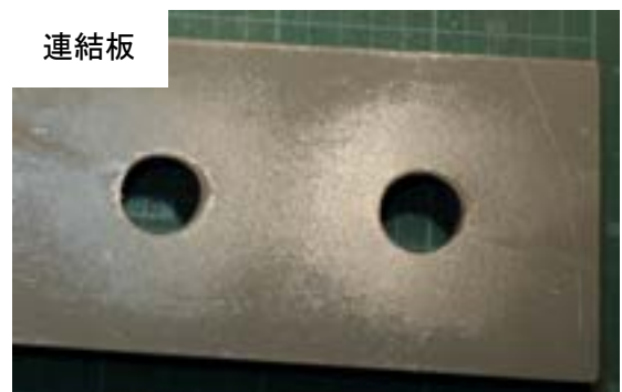
付図 3-2-3 試験体 A-b-3 すべり面の状況（左：ボルト側，右：ナット側）
