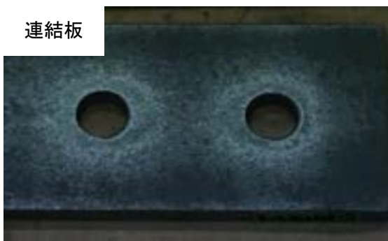
付図 3-3-3 試験体 B-b2-3 すべり面の状況 (左 : ボルト側, 右 : ナット側)
