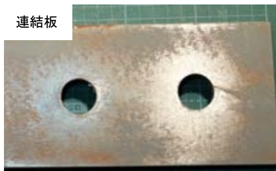
付図 3-2-13 試験体 B-a-1 すべり面の状況（左：ボルト側，右：ナット側）
