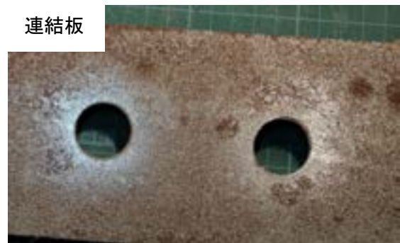
付図 3-2-17 試験体 C-b-2 すべり面の状況 (左：ボルト側, 右：ナット側)
