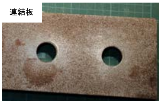
付図 3-2-3 試験体 A-b-3 すべり面の状況（左：ボルト側，右：ナット側）
