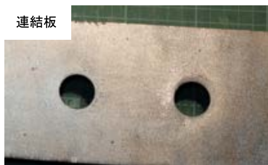
付図 3-2-21 試験体 C-v-3 すべり面の状況（左：ボルト側，右：ナット側）
