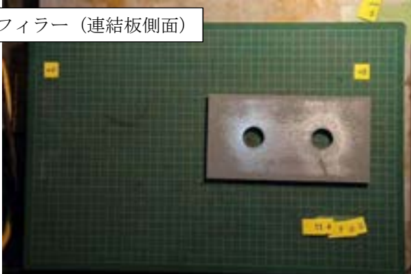
付図 1-3-10 試験体 P3-20-1 すべり面の状況 (左: ボルト側, 右: ナット側)
