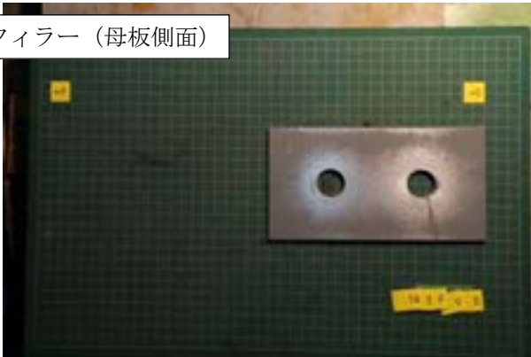
付図 1-3-15 試験体 P4-15-3 すべり面の状況 (左: ボルト側, 右: ナット側)
