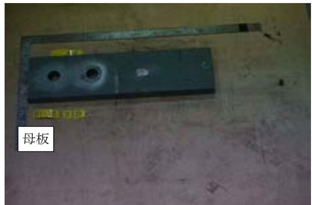
付図 1-3-46 試験体 PB2-15-1 すべり面の状況 (左: ボルト側, 右: ナット側)
