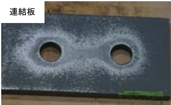
付図 3-3-17 試験体 C-i2-2 すべり面の状況 (左：ボルト側, 右：ナット側)
