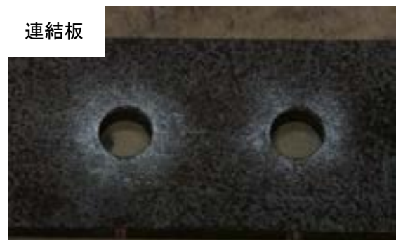
付図 3-3-10 試験体 C-b2-1 すべり面の状況 (左 : ボルト側, 右 : ナット側)
