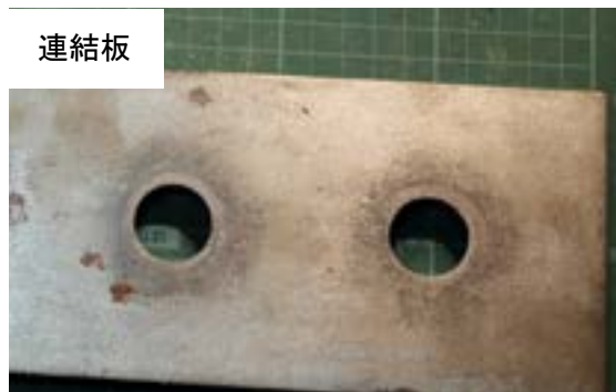
付図 3-2-20 試験体 C-v-2 すべり面の状況 (左 : ボルト側, 右 : ナット側)
