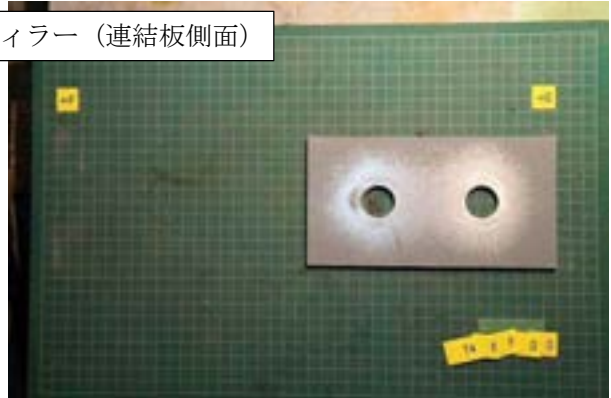
付図 1-3-17 試験体 P4-20-2 すべり面の状況 (左: ボルト側, 右: ナット側)
