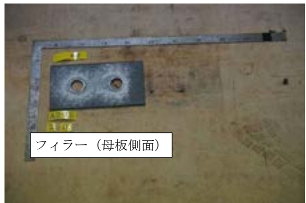
付図 1-3-42 試験体 PA3-15-3 すべり面の状況 (左 : ボルト側, 右 : ナット側)
