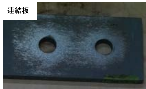
付図 3-3-9 試験体 B-n2-3 すべり面の状況 (左 : ボルト側, 右 : ナット側)
