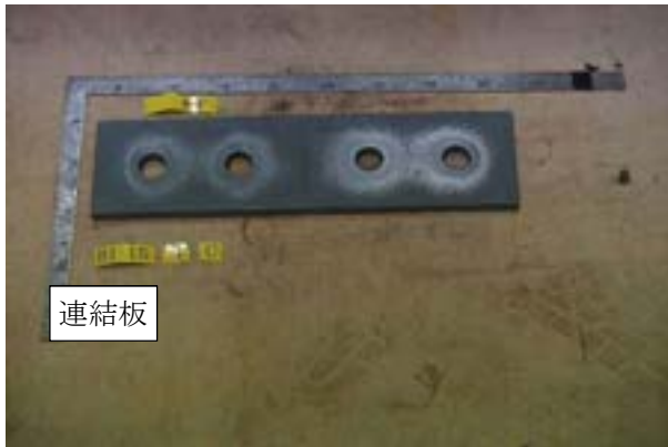
付図 1-3-46 試験体 PB2-15-1 すべり面の状況 (左: ボルト側, 右: ナット側)
