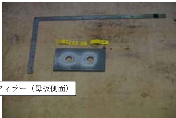
付図 1-3-50 試験体 PB3-15-2 すべり面の状況（左：ボルト側，右：ナット側）
