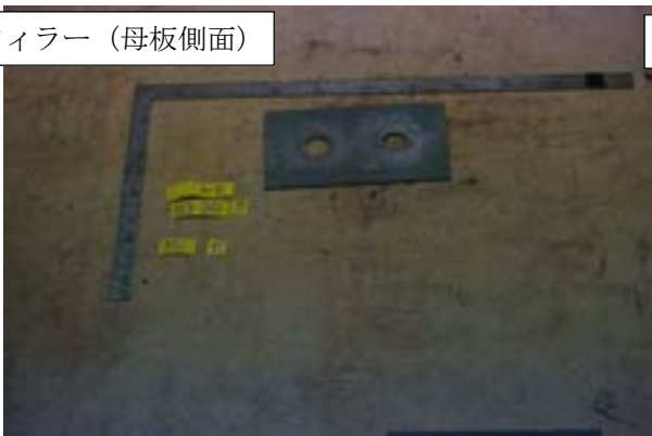
付図 1-3-54 試験体 PB4-20-3 すべり面の状況 (左: ボルト側, 右: ナット側)
