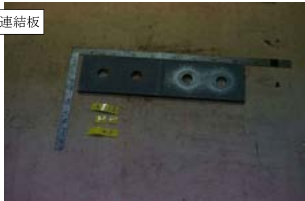
付図 1-3-37 試験体 PA2-15-1 すべり面の状況 (左: ボルト側, 右: ナット側)
