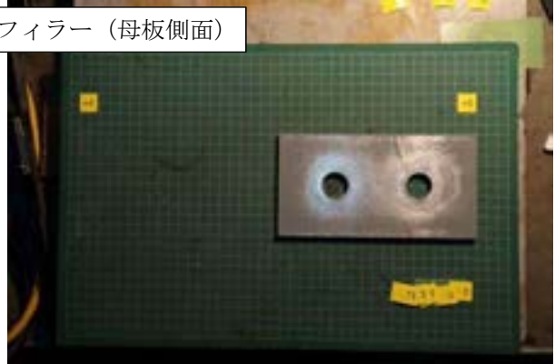
付図 1-3-9 試験体 P3-15-3 すべり面の状況 (左 : ボルト側, 右 : ナット側)
