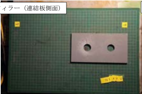
付図 1-3-7 試験体 P3-15-1 すべり面の状況 (左 : ボルト側, 右 : ナット側)
