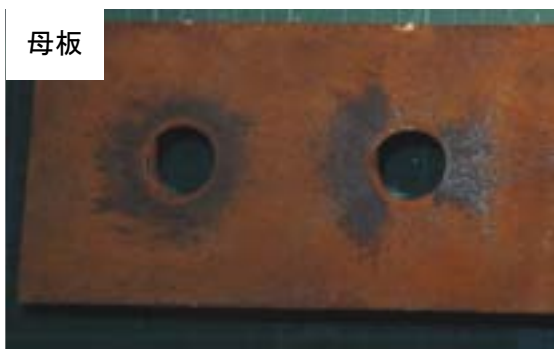
付図 3-2-31 試験体 C-a-1 すべり面の状況（左：ボルト側，右：ナット側）
