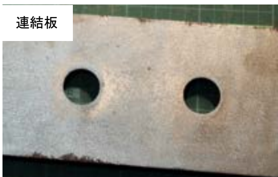
付図 3-2-20 試験体 C-v-2 すべり面の状況 (左 : ボルト側, 右 : ナット側)
