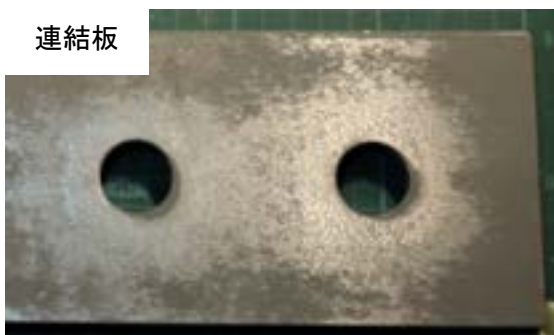
付図 3-2-8 試験体 B-v-2 すべり面の状況（左：ボルト側，右：ナット側）
