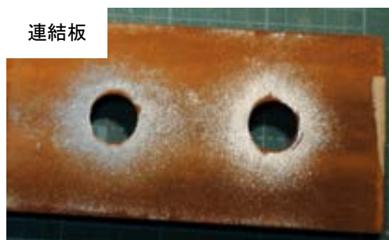
付図 3-2-5 試験体 A-n-2 すべり面の状況（左：ボルト側，右：ナット側）
