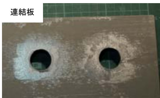
付図 3-2-10 試験体 B-o-1 すべり面の状況（左：ボルト側，右：ナット側）
