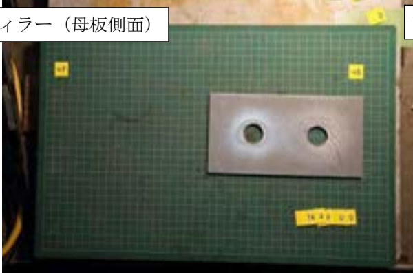
付図 1-3-16 試験体 P4-20-1 すべり面の状況 (左: ボルト側, 右: ナット側)
