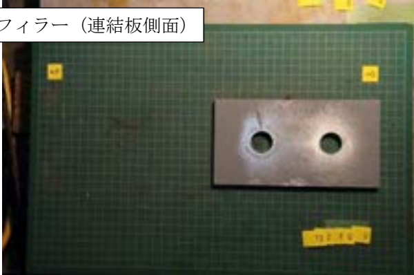
付図 1-3-8 試験体 P3-15-2 すべり面の状況 (左 : ボルト側, 右 : ナット側)
