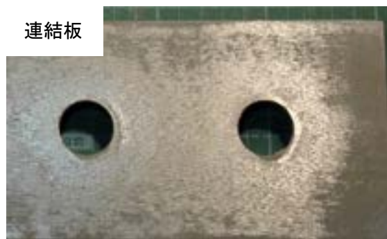
付図 3-2-9 試験体 B-v-3 すべり面の状況（左：ボルト側，右：ナット側）
