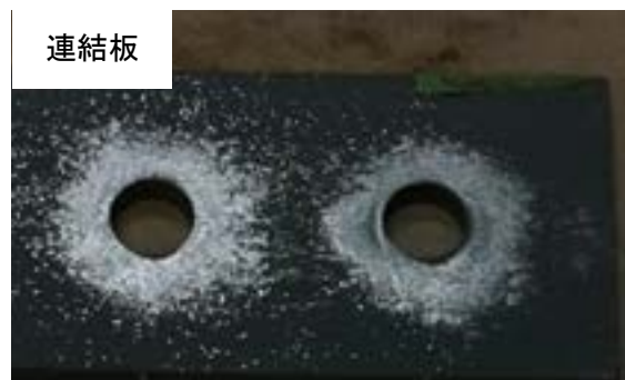
付図 3-3-6 試験体 B-g-3 すべり面の状況 (左: ボルト側, 右: ナット側)
