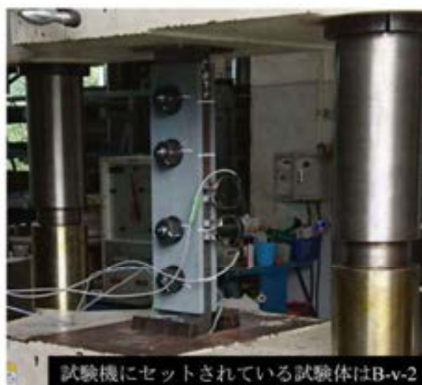
図3-4-1 すべり耐力試験の状況
