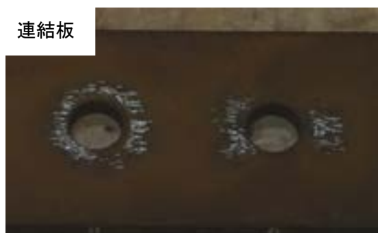
付図 3-3-21 試験体 C-n2-3 すべり面の状況 (左：ボルト側, 右：ナット側)
