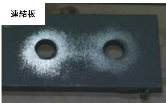
付図 3-3-4 試験体 B-g-1 すべり面の状況 (左 : ボルト側, 右 : ナット側)
