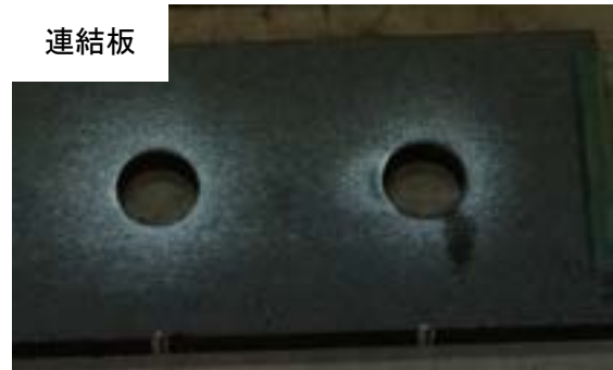
付図 3-3-11 試験体 C-b2-2 すべり面の状況 (左：ボルト側, 右：ナット側)
