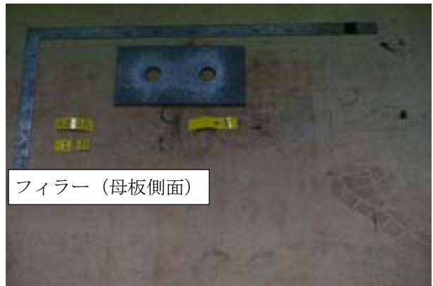
付図 1-3-40 試験体 PA3-15-1 すべり面の状況 (左: ボルト側, 右: ナット側)
