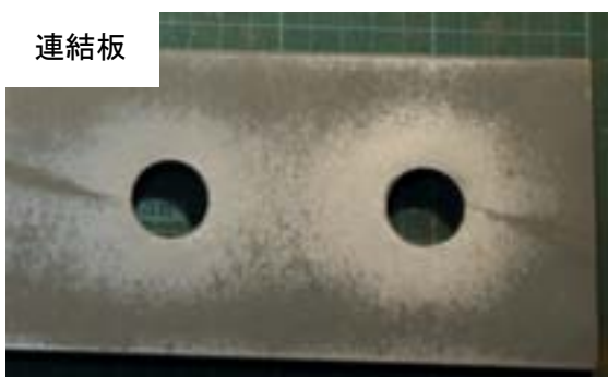
付図 3-2-22 試験体 C-i-1 すべり面の状況（左：ボルト側，右：ナット側）
