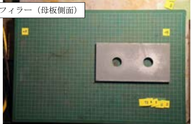
付図 1-3-10 試験体 P3-20-1 すべり面の状況 (左: ボルト側, 右: ナット側)
