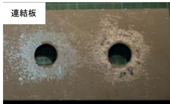
付図 3-2-25 試験体 C-o-1 すべり面の状況 (左 : ボルト側, 右 : ナット側)
