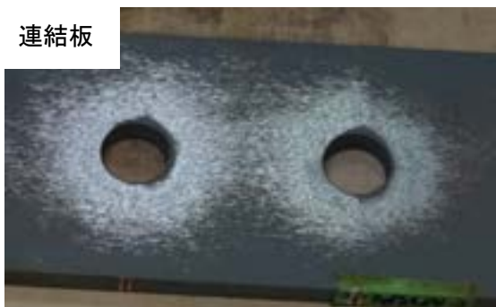
付図 3-3-9 試験体 B-n2-3 すべり面の状況 (左 : ボルト側, 右 : ナット側)
