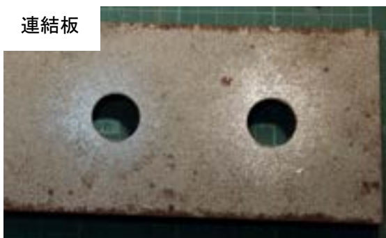
付図 3-2-16 試験体 C-b-1 すべり面の状況 (左：ボルト側, 右：ナット側)
