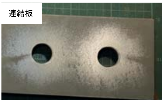
付図 3-2-24 試験体 C-i-3 すべり面の状況 (左：ボルト側, 右：ナット側)
