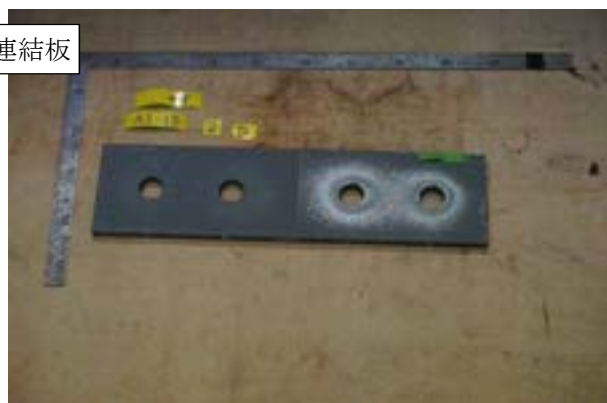
付図 1-3-38 試験体 PA2-15-2 すべり面の状況 (左: ボルト側, 右: ナット側)
