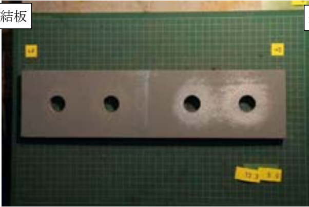
付図 1-3-6 試験体 P2-15-3 すべり面の状況 (左: ボルト側, 右: ナット側)
