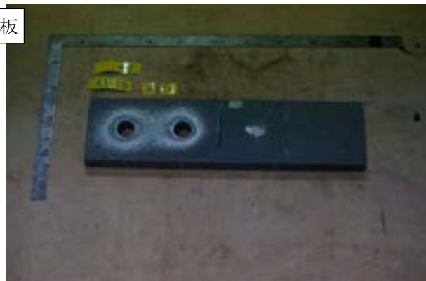
付図 1-3-37 試験体 PA2-15-1 すべり面の状況 (左: ボルト側, 右: ナット側)
