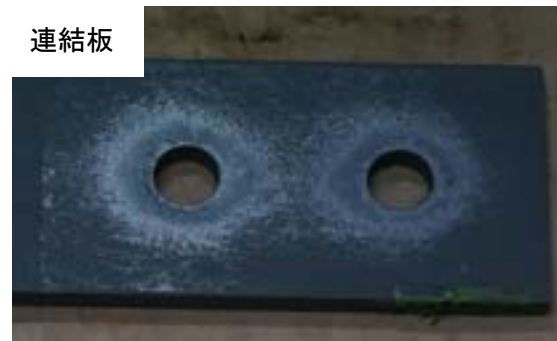
付図 3-3-18 試験体 C-i2-3 すべり面の状況 (左：ボルト側, 右：ナット側)
