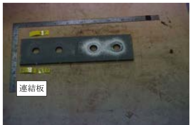
付図 1-3-47 試験体 PB2-15-2 すべり面の状況 (左: ボルト側, 右: ナット側)
