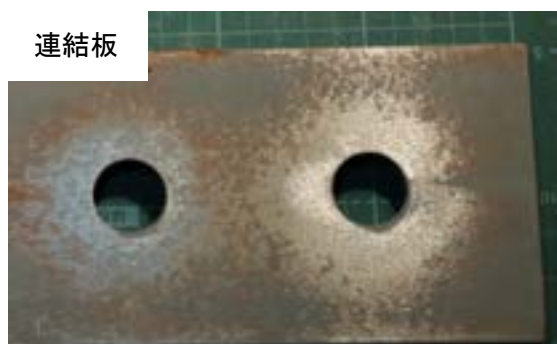
付図 3-2-14 試験体 B-a-2 すべり面の状況（左：ボルト側，右：ナット側）
