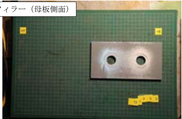
付図 1-3-7 試験体 P3-15-1 すべり面の状況 (左 : ボルト側, 右 : ナット側)
