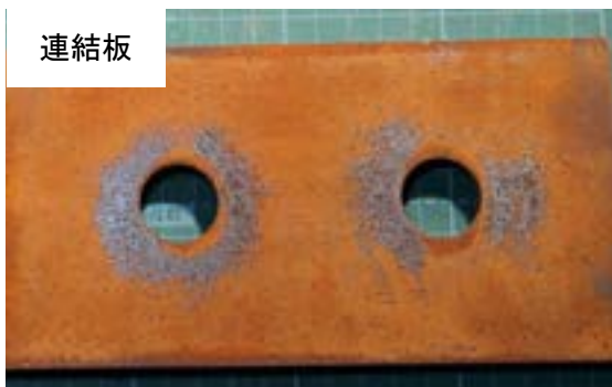
付図 3-2-32 試験体 C-a-2 すべり面の状況（左：ボルト側，右：ナット側）
