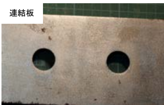
付図 3-2-19 試験体 C-v-1 すべり面の状況 (左 : ボルト側, 右 : ナット側)
