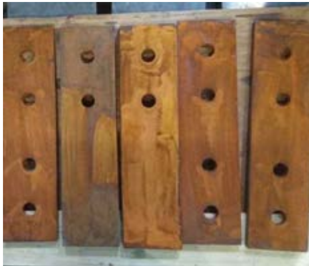
図 3-2-4 室内における接触面 a の乾燥状況
