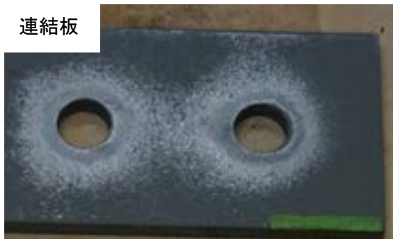
付図 3-3-16 試験体 C-i2-1 すべり面の状況 (左：ボルト側, 右：ナット側)
