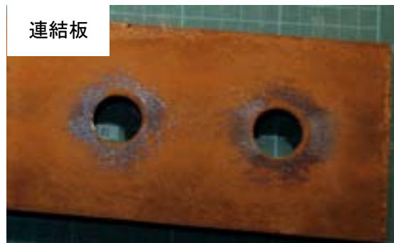
付図 3-2-6 試験体 A-n-3 すべり面の状況（左：ボルト側，右：ナット側）
