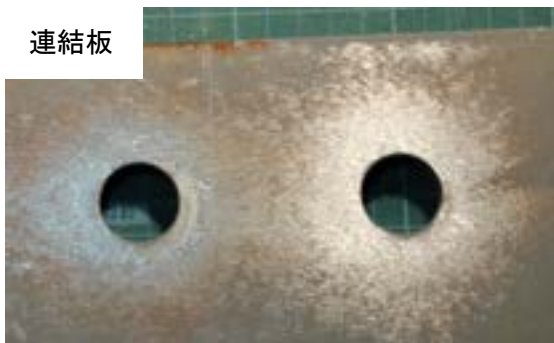
付図 3-2-15 試験体 B-a-3 すべり面の状況 (左：ボルト側, 右：ナット側)
