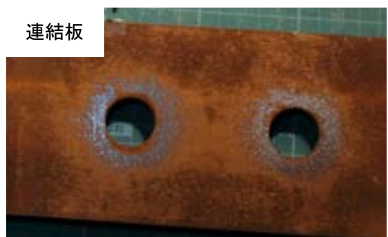
付図 3-2-4 試験体 A-n-1 すべり面の状況（左：ボルト側，右：ナット側）
