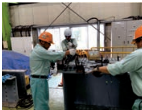
図 3-3-2 ボルト締付け時の状況 (B 社その 2)
