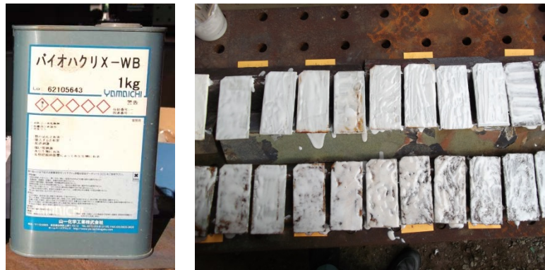
図 3-17 塗膜剥離剤および塗布後の試験体
