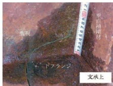
写真-3 A2側支承ソールプレート上のき裂
