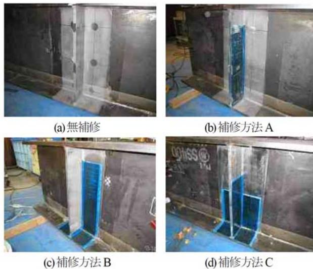
図 4-4-17 CFRP 接着後の外観
