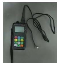
図-3 超音波厚さ計 (5MHZ)
