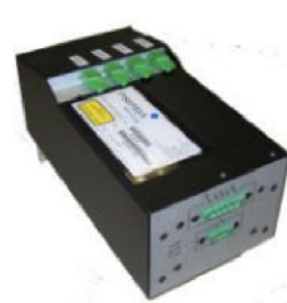
FBG 用 FSI ユニット (1ch : 350 万円/機, 4ch : 420 万円/機)
