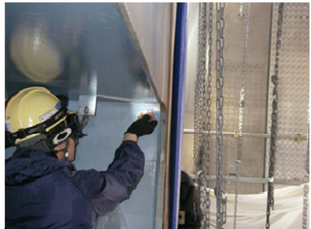
(b) ひずみゲージ貼付状況
