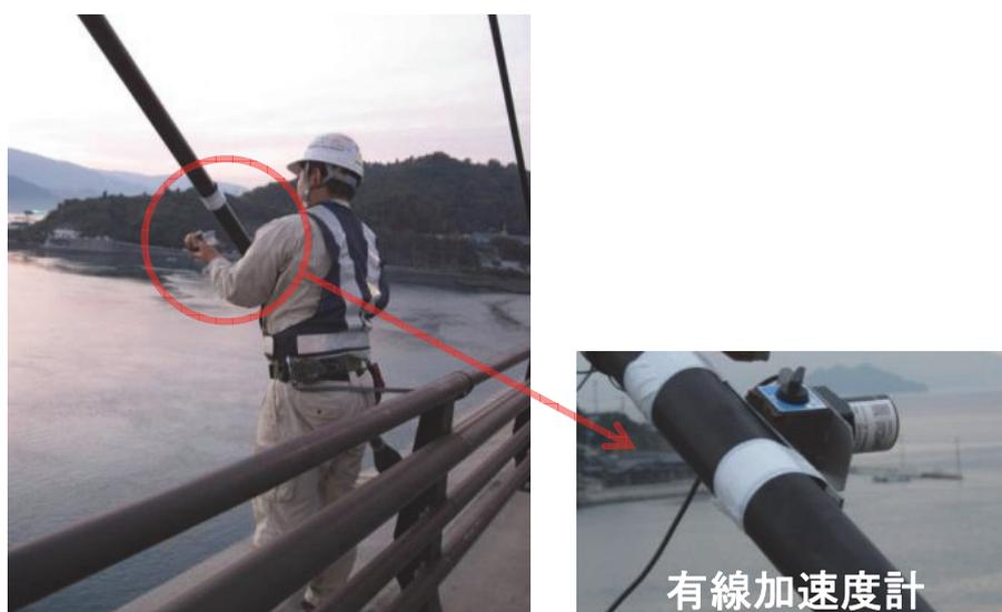
図 3-53 従来のケーブル張力計測方法
