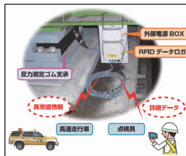
図 2-42 小型振動発電デバイスの概要図 2) 図 2-43 ゴム支承反力測定システムの概要図 3)
