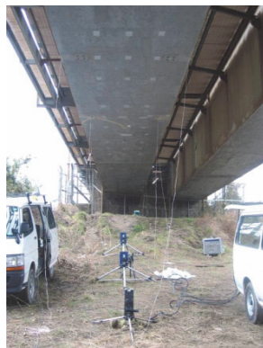
図 2-83 鋼箱桁橋への適用
