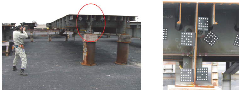
図 4-1-4 デジタルカメラによる計測状況
