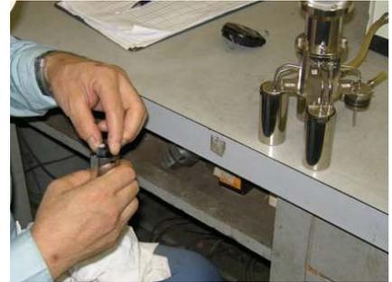
(9) 捕集容器への試料挿入
