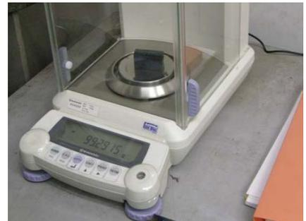
(12) 試料の質量測定
